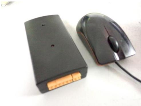
Les extensions peuvent être alimentées par toute source de 5V à 36V (même voltage en sortie).
